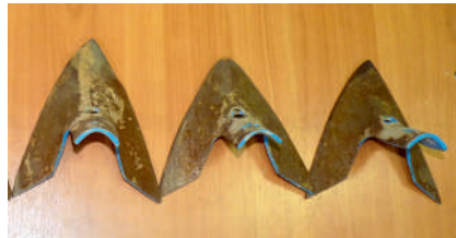
Рисунок 2 – Результат абразивного изнашивания долотообразных (а) и стрелчатых (б) лап культиваторов
